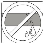
Проверьте отсутствие протечек в дренажной системе
