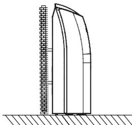
Порядок установки монтажной пластины кабелепровода (при наличии в комплекте поставки)
