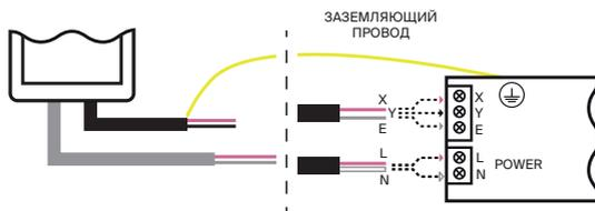
Для подключения к клемме «X Y E» используйте 3-х жильный провод AWG24 с экранированием, экран этого провода необходимо заземлить.
