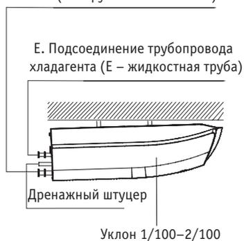
E. Подсоединение трубопровода хладагента (E – жидкостная труба)
