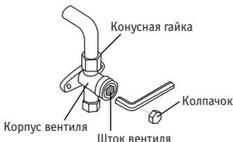
12. С помощью шестигранного ключа полностью откройте клапаны высокого и низкого давления.
