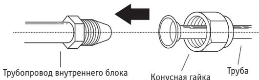
3. Затяните конусную гайку вручную до упора.
