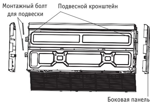
8. Навесьте внутренний блок на подвесные монтажные болты. Установите внутренний блок горизонтально, используя уровень, в противном случае могут происходить протечки дренажа.
