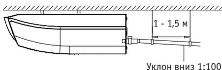
1. Чтобы предотвратить образование конденсата и течь, оберните трубу теплоизоляцией.
