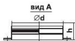
Фланцы FGV с резиновым уплотнителем для присоединения вентиляторов к воздуховодам. Изготовлены из оцинкованной стали.
