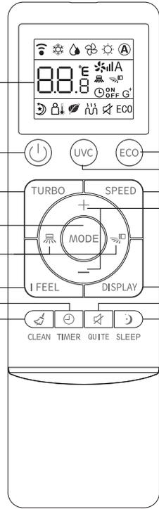
8. Кнопка **TIMER** - активация таймера на включение и выключение.
